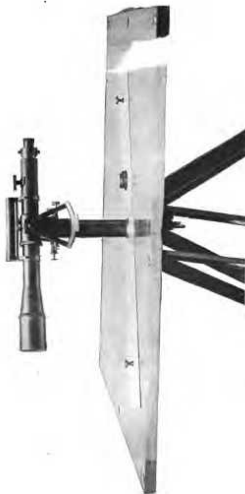
Plane Table and Telescopic Alidade. (U. S. Geological Survey System.)
